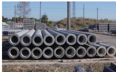
石炭灰の有効利用コンクリートパイプ (日本海コンクリート工業が製造)
